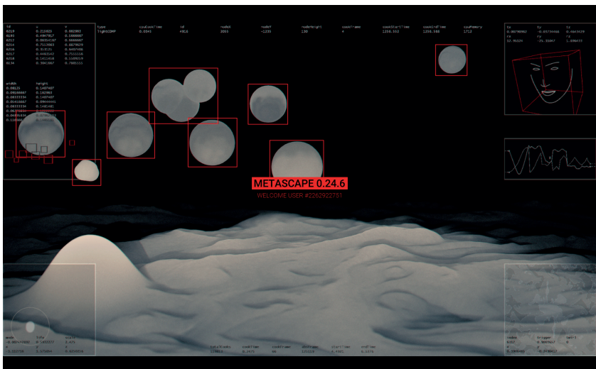
Фиг. 19. Визуализация от интерактивната инсталация Metascope (2022) на Петко Танчев. За моделирането на геометричния терен в проекта са използвани генеративни Noise оператори в комбинация с GLSL шейдъри и персонализирана мрежа от филтри за постобработка.
